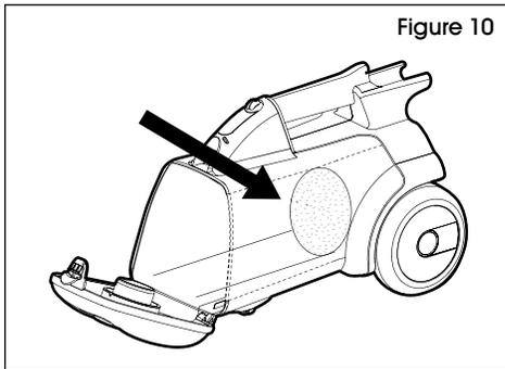
5. Un sac ouvert est légèrement replié. Placez le sac dans l'aspirateur. Insérez les coins du sac sous le collet. Fermez le couvercle de sac en vous assurant qu'il est fermement enclenché. (Voir Figure 11)
