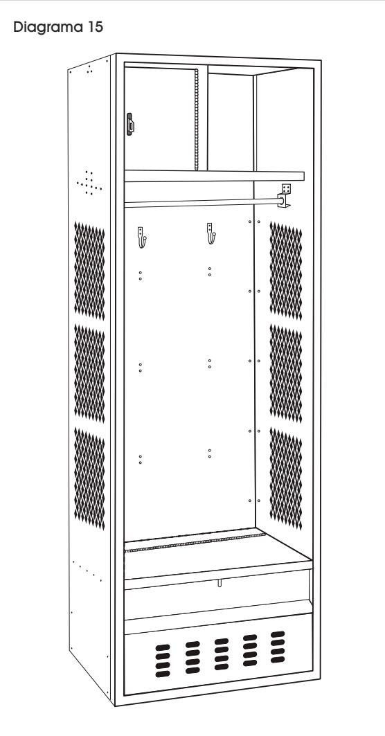
16. Atornille un soporte para la barra para prendas (14) a uno de los lados (2). Luego, inserte la barra para prendas (13) al soporte para la barra para prendas (14) que está unido al lateral con perno (2). Coloque el segundo soporte para la barra para prendas (14) sobre el otro extremo de la barra para prendas (13). Una el segundo soporte para la barra para prendas (14) a uno de los lados (2) con perno. (Vea Diagrama 14)
