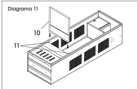
13. Atornille el panel rectangular más pequeño de la cubierta del cajón inferior (10) a los rieles del cajón inferior (11) en ambos lados. El pestillo para candado en la cubierta del cajón inferior (10) debe alinearse con el pestillo en el frente del cajón inferior (9). (Vea Diagrama 12)
