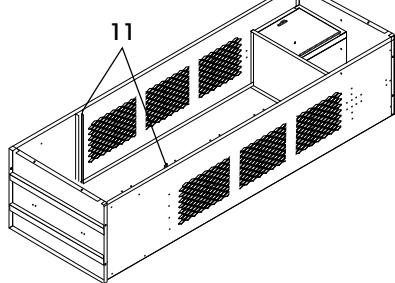
10. Alignez le cadre (5) avec le haut des côtés (2) et placez-le sur l'unité. Les coins du bord inférieur du cadre sont dotés d'encoches rectangulaires. Boulonnez le cadre (5) aux côtés (2). (Voir Figure 9)
